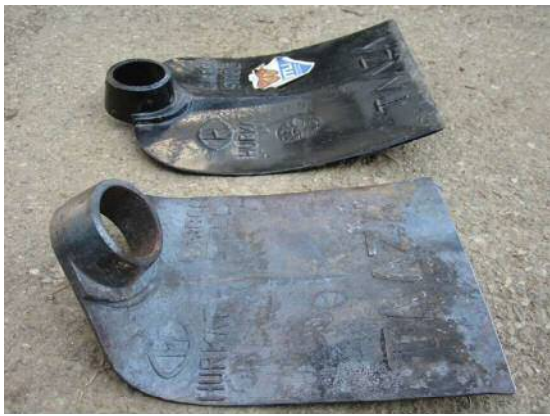
写真④ 奥が既存の鍬、手前が角度調整後の鍬
